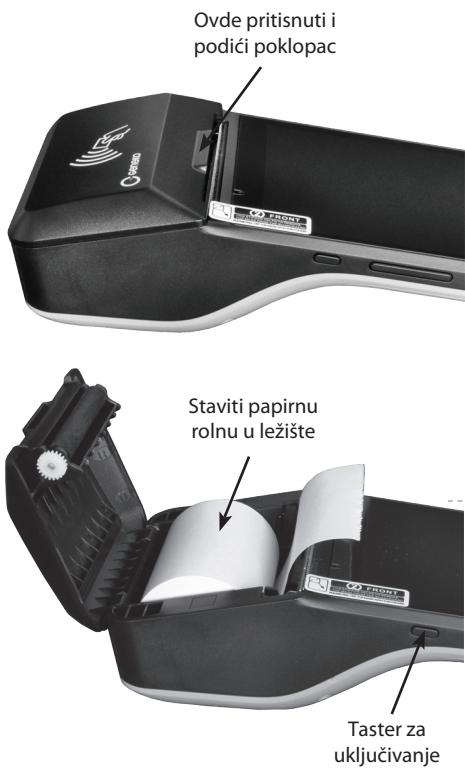
3. Uredaj se uključuje pritiskom na taster prikazan na slici.
