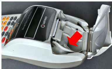
Otvoren poklopac papirne trake na kasi i pozicija holdera za micro SD karticu
